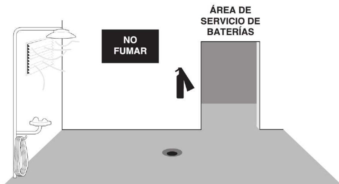
Las instalaciones para la carga de baterías se deben localizar en las áreas designadas para tal fin. Estas áreas se deben mantener libres de cualquier material combustible no esencial.
