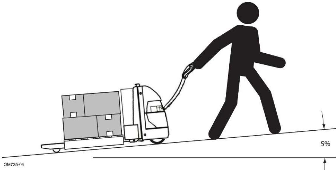
Siempre mantenga las horquillas hacia abajo o sin carga y en posición levantada cuando trabaje en una pendiente. Los montacargas están diseñados para moverse hasta un máximo de pendiente de 5% con o sin carga.
