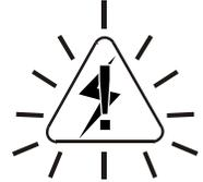
Cuando la luz indicadora **destella, ha ocurrido una falla en el sistema**, lo que podría detener el funcionamiento de la máquina. Revise el indicador MDI en el puesto de controles de suelo para ver si se visualiza un código de falla para diagnóstico (DTC). Una explicación de los códigos DTC se muestra en la Sección 5.10.
