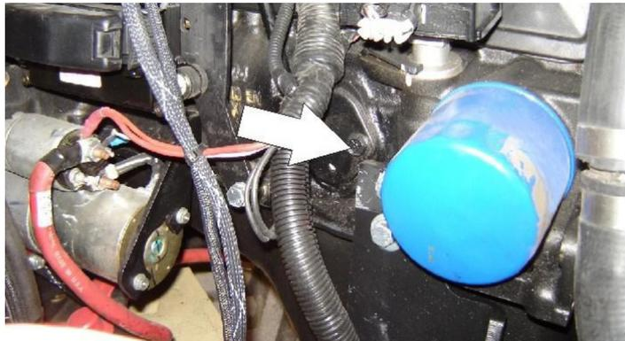
Punto(s) de lubricación - Tapa de llenado/elemento enroscable
