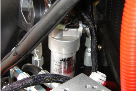
Intervalo - Cambiar después de las primeras 50 horas y cada 6 meses o 300 horas de allí en adelante, según lo requiera el indicador de condición.
